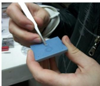
Figura 5.41: Desmoldado del reservorio de electrolito, experiencia 4..
