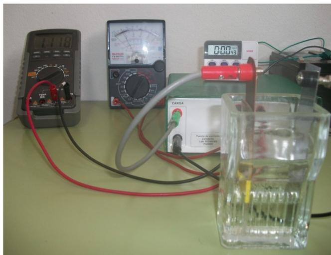
Figura 4.13: Celda de depósito de PPy(DBS)
