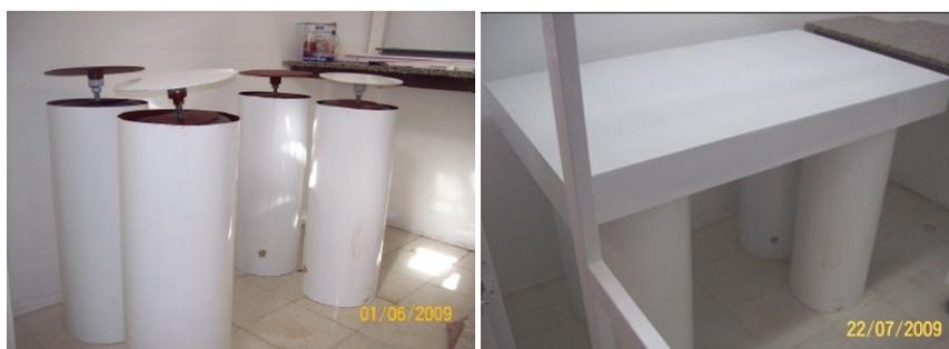
Figura 7.21: Mesa de trabajo con amortiguamiento neumático.
