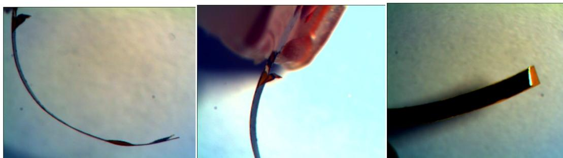
Figura 4.27: Delaminación en el actuador Kapton-Au-PPy(DBS)
