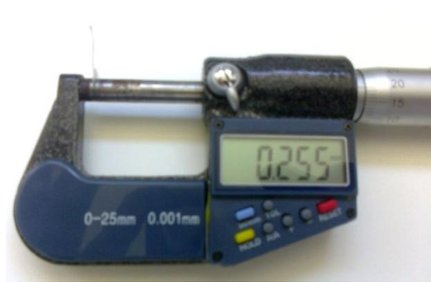
Figura 7.29: Válvula de Ahmed - Medición del espesor de la membrana
