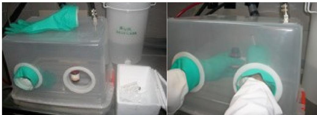
Figura 7.18: Cámara anaeróbica para la manipulación del monómero
