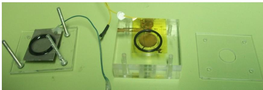
Figura 4.18: Módulo de celda electroquímica.
