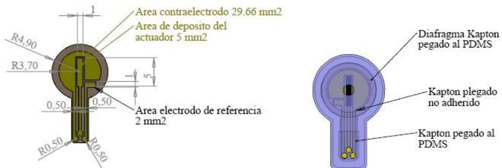
Figura 5.34: Montaje del diafragma al reservorio de electrolito, válvula experiencia 4.
