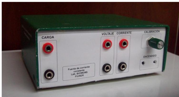
Figura 7.16: Fuente de corriente ajustable para electropolimerización
