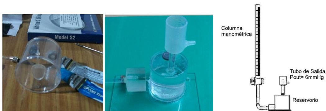
Figura 5.62: Circuito hidráulico para el ensayo de la válvula
