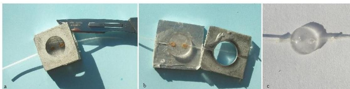
Figura 5.18: Desmoldado de la base de la válvula.
