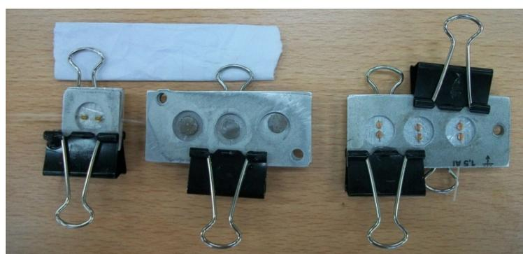
Figura 5.17: Moldes de microfluidica y reservorio de electrolito.
