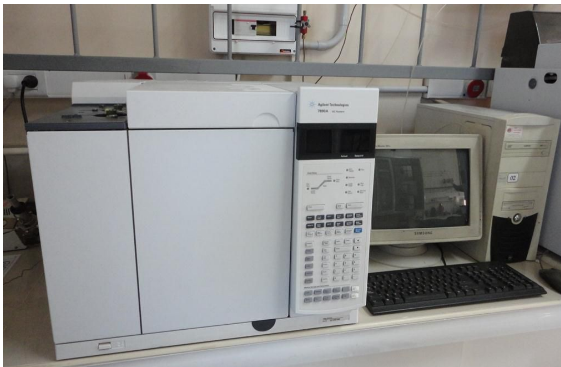
Figura IV.3: Equipo de determinación analítica: Cromatógrafo gaseoso con detector FID, Agilent 7890 A.
