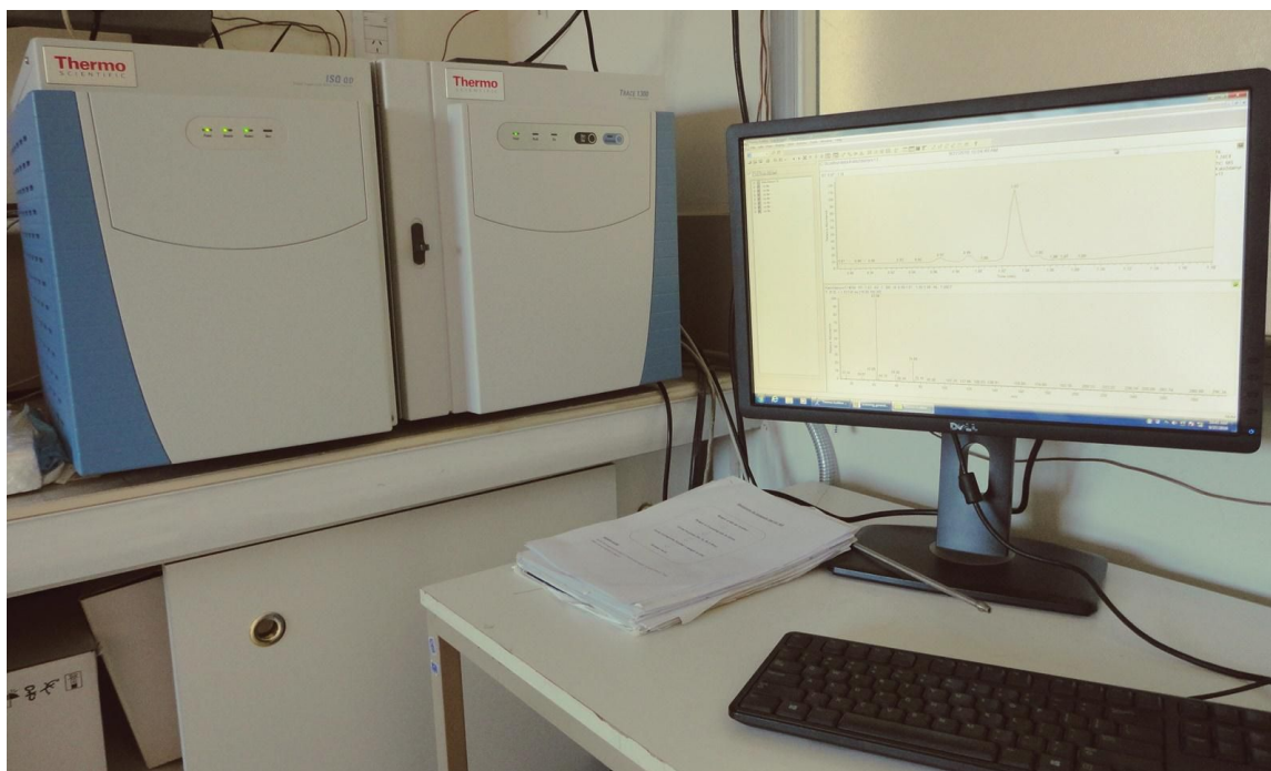
Figura IV.4: Equipo de determinación analítica: Cromatógrafo gaseoso con detector de masas, Thermo Scientific.
