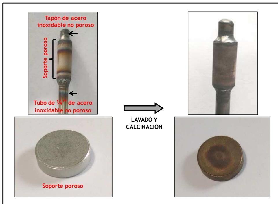
**Figura 2.1.** Soportes planos y tubulares antes y después de acondicionamiento.
