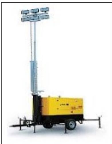
En general, tal como se advierte en la Ilustración 6, suelen estar compuestas por un GE al cual se le agrega un mástil al que se le acoplan también soportes de lámparas halógenas. Tienen una altura de hasta 10 metros, aunque el mástil elevarse o plegarse cuando no es utilizada la torre. También cuenta con estabilizadores o brazos de apoyo que deben desplegarse antes de elevar la torre para que el equipo no pierda estabilidad.
