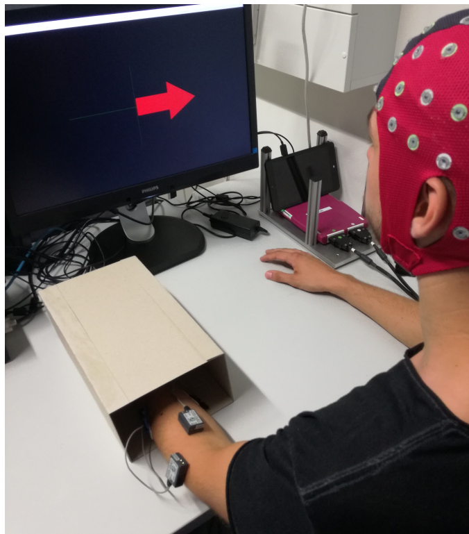
Figura 7.4: Montaje del experimento para un sujeto con dominancia izquierda. Se muestran los sistemas de adquisición de EEG y EMG, como así también el protocolo de estimulación con la señal visual para una época de MI
