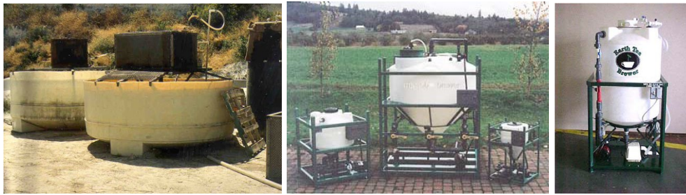
Fig. 29. Diferentes modelos de extractores Micro Brewer. A la izquierda, extractor de 15141 l, en el centro extractores de 45 l, 189 l y 1892 l, y a la derecha extractor de 378 l de EPM Inc. Tomado de Diver (2002).
