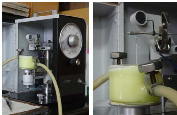
**Figura 3.1.** Tensiómetro semiautomático.
