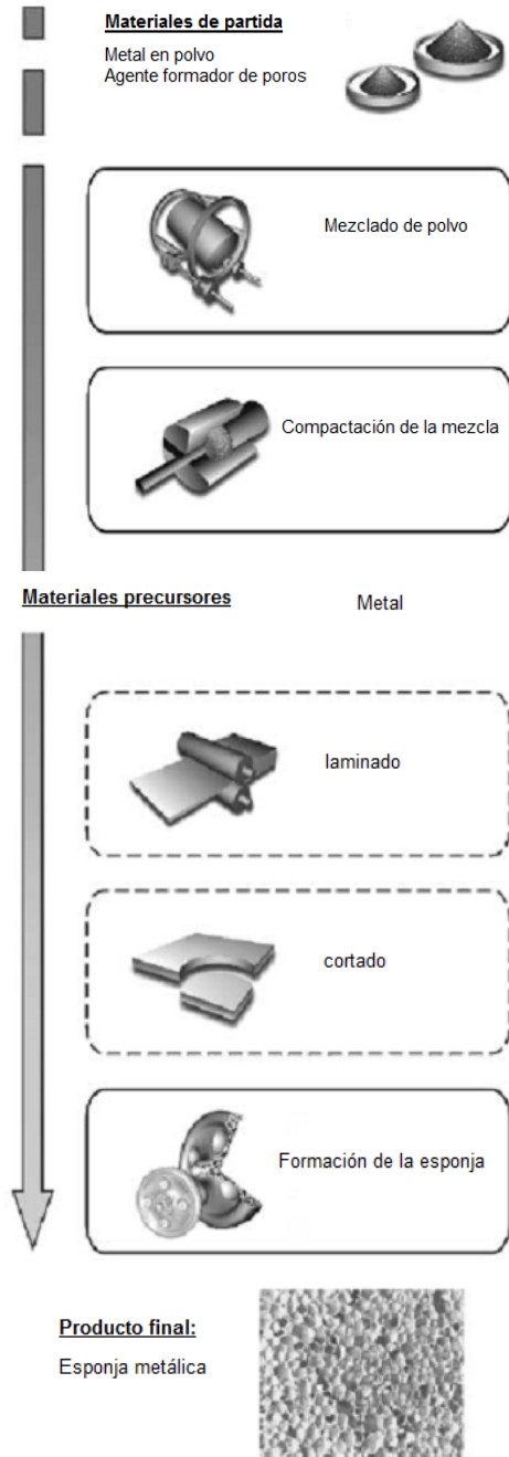
Figura 1.13: Pasos del método de fabricación de esponja metálica por el método de liberación de gas.
