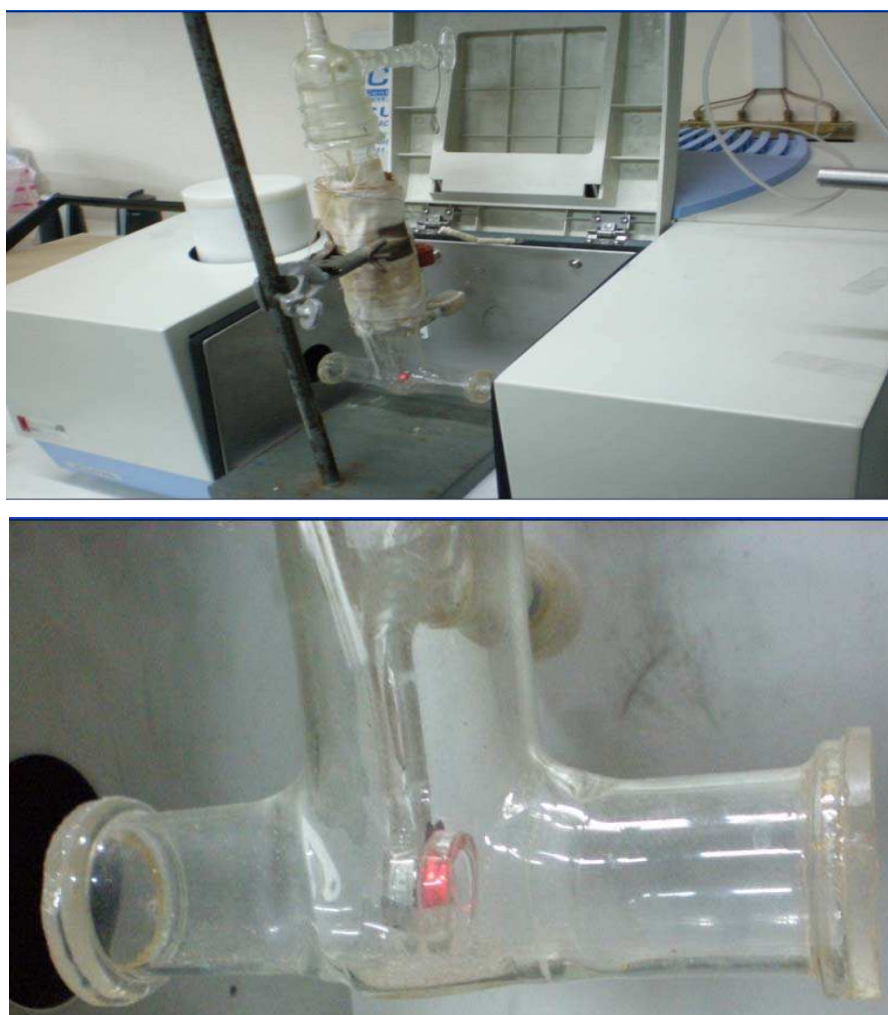
Figura. 8: Celda de Infrarrojo empleada para realizar los experimentos de adsorción y desorción de tolueno.
