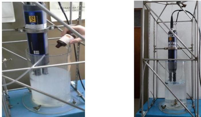
**Figura 1:** Reactor de acrílico con sonda multiparamétrica sobre bastidor. Introducción de formazina
