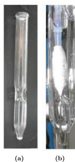
Figura 2.4: Electrodo de referencia: (a) capilar de vidrio con estrangulaciones, (b) electrodo de burbuja de hidrógeno.
