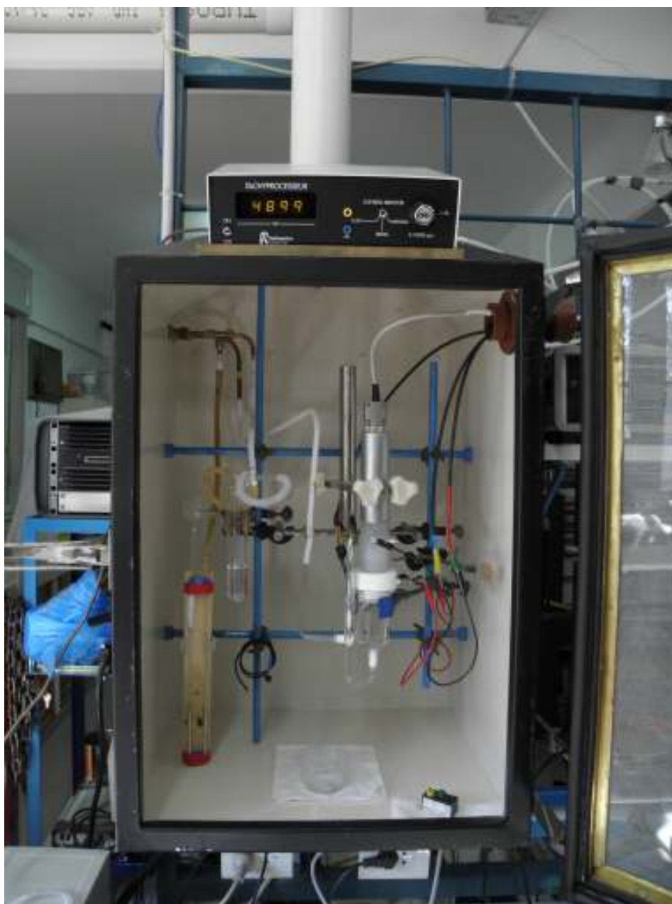
Figura 2.9: Interior de la campana de extracción de CO .
