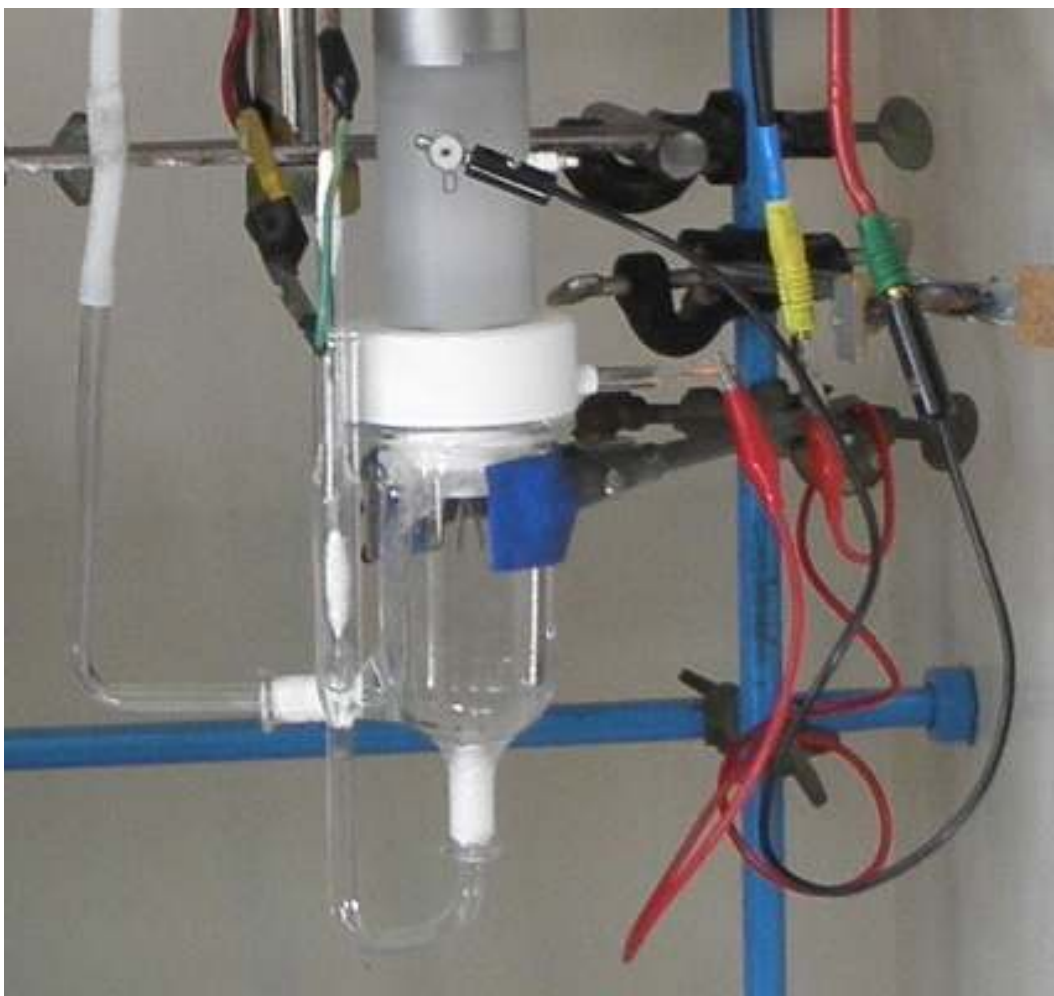
Figura 2.1: Fotografía de la celda de tres electrodos.
