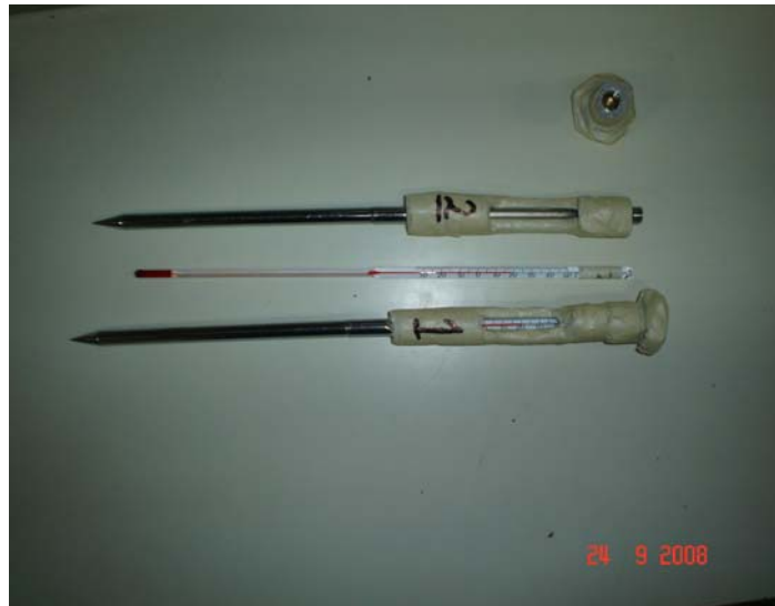
Figura 6: Termómetro de alcohol, la vaina de acero que lo recubre y un aislamiento térmico hecho con poliuretano expandido, que aísla la vaina y el termómetro del sol y la temperatura en la parte que queda expuesta por sobre la superficie del suelo.
