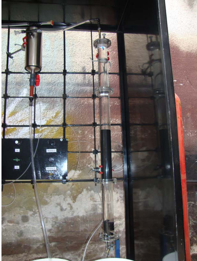
Figura 4: Reactor de acrílico y separador gas-líquido construido en acero inoxidable.
