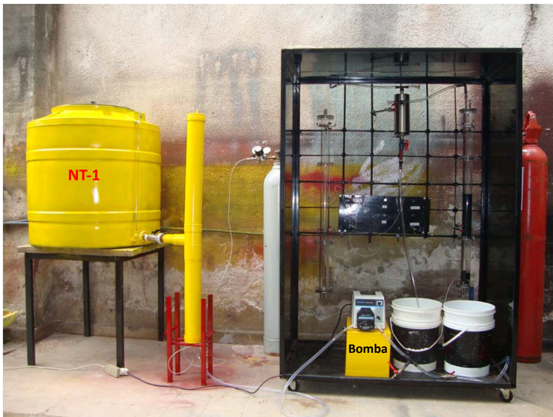
Figura 3: Equipo móvil de purificación de agua contaminada con nitratos o nitritos NT-1.
