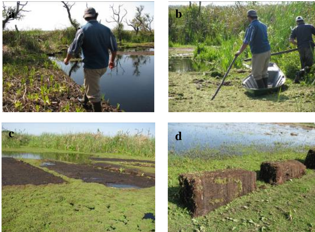
Figura 14. Turba subtropical extraída en forma manual. a) Turba subtropical sobre el arroyo b) Se llega a la turba con canoas c) Se corta con serruchos y se lleva flotando hasta la costa d) Bloques de turba subtropical.
