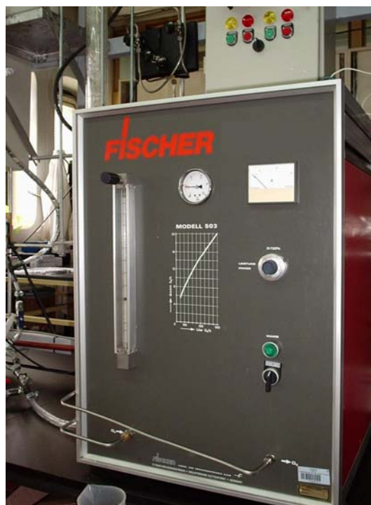
Figura 4.4: Detalles del Dispositivo Experimental para la Degradación de DCA vía O_3/UV
