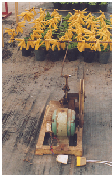
Figura 4.1: Dispositivo utilizado para producir el acondicionamiento mecánico a los plantines de petunias y tagetes
