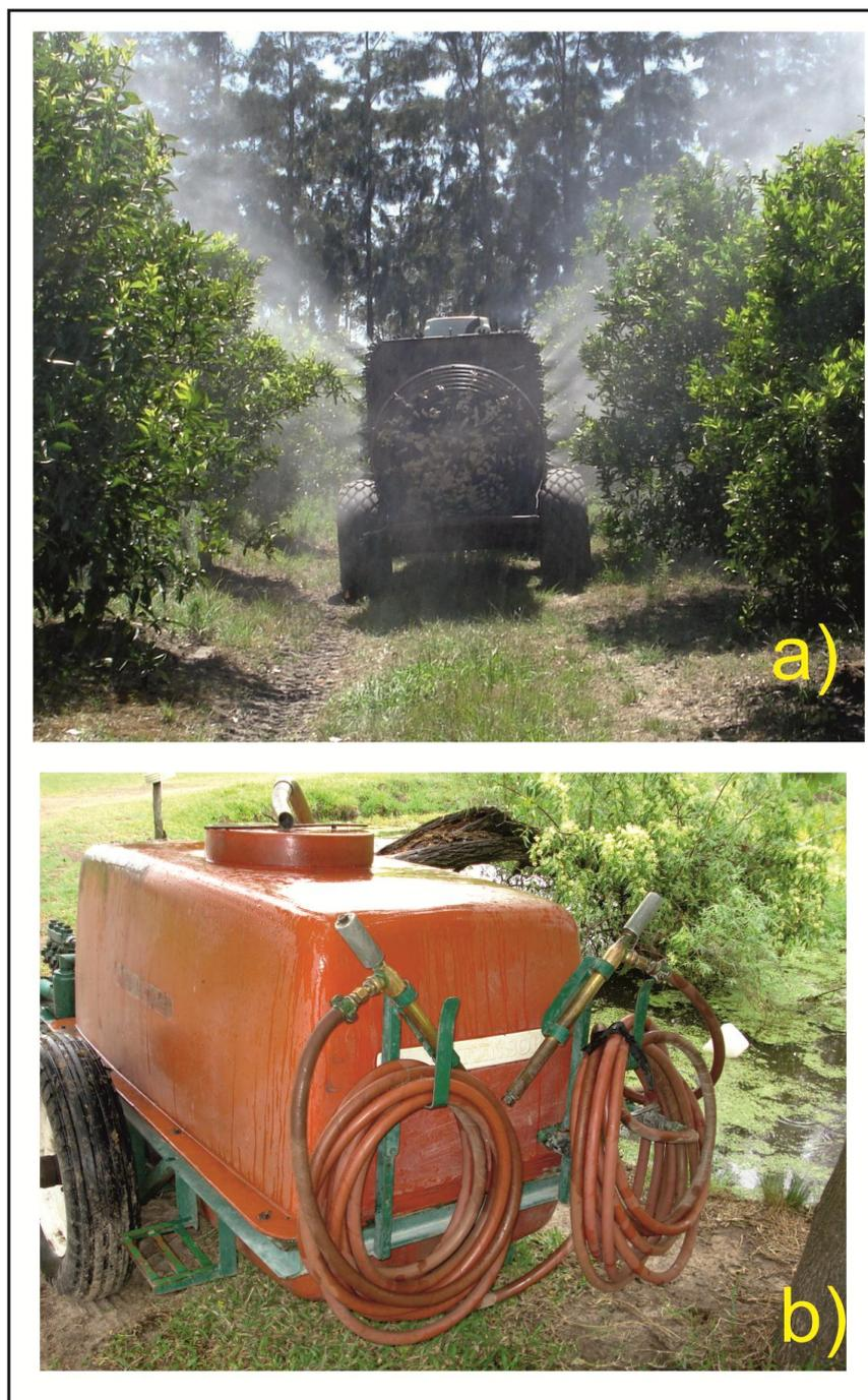
**FIGURA 6.** Máquinas pulverizadoras utilizadas en citricultura en las aplicaciones contra las cochinillas.
