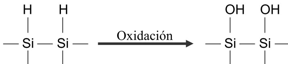
**Figura 4.1.** Esquema simplificado de la oxidación del SP.
