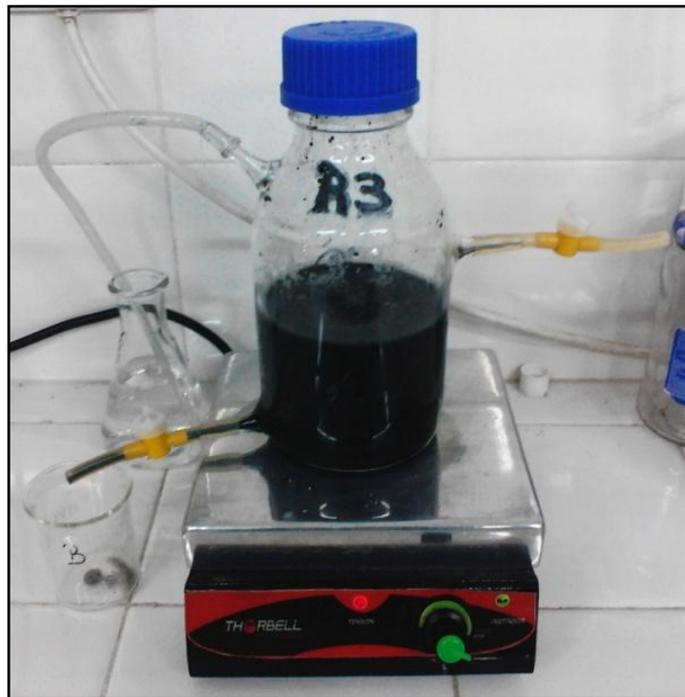
**Figura VI. 4.** Fotografía del reactor anaeróbico utilizado en las experiencias.
