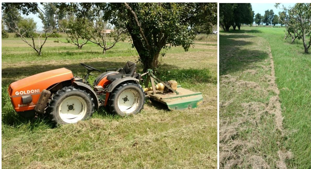
Figura N°6. Desmalezadora de enganche con hélice (izq.) Labor realizada con el implemento en plantaciones de duraznero (der.) (Módulo Fruticultura FCA-UNR).
