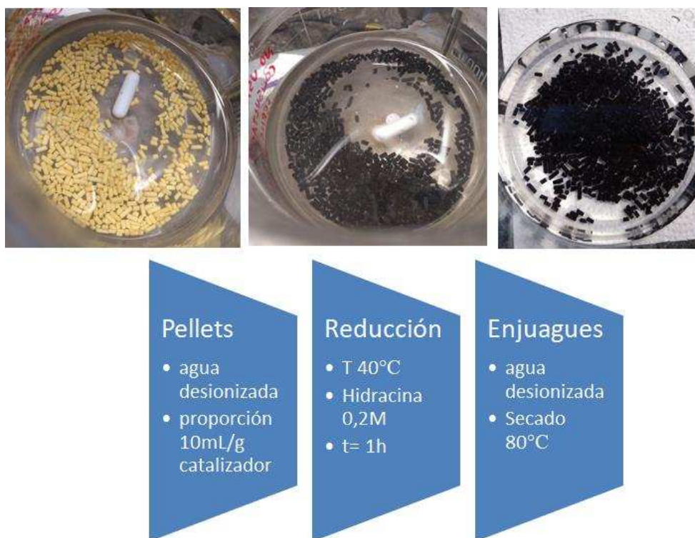
Figura 2. 6. Esquema de la reducción en la etapa de síntesis de los catalizadores soportados en pellets de alúmina.
