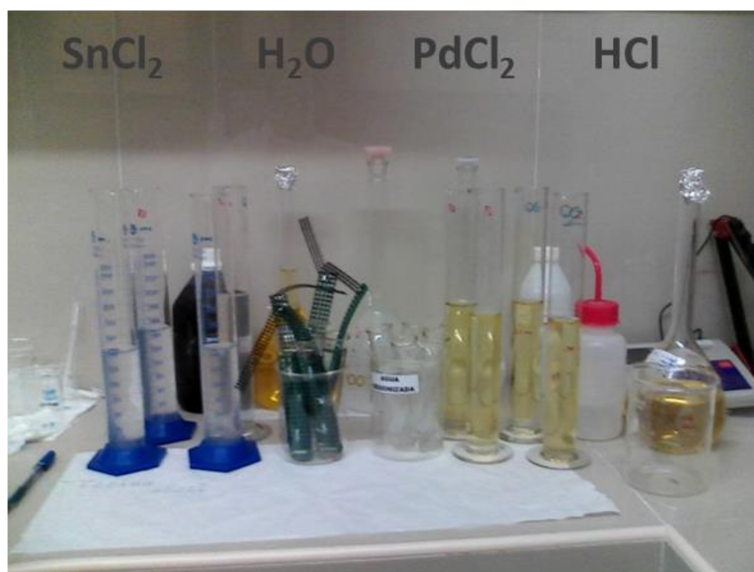
Figura 2. 8. Etapa de activación en la síntesis catalítica.
