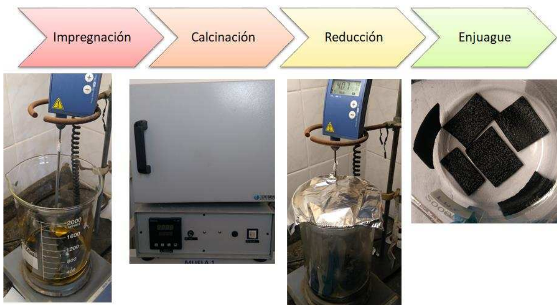
Figura 2. 11. Impregnación húmeda en fibras de carbono.
