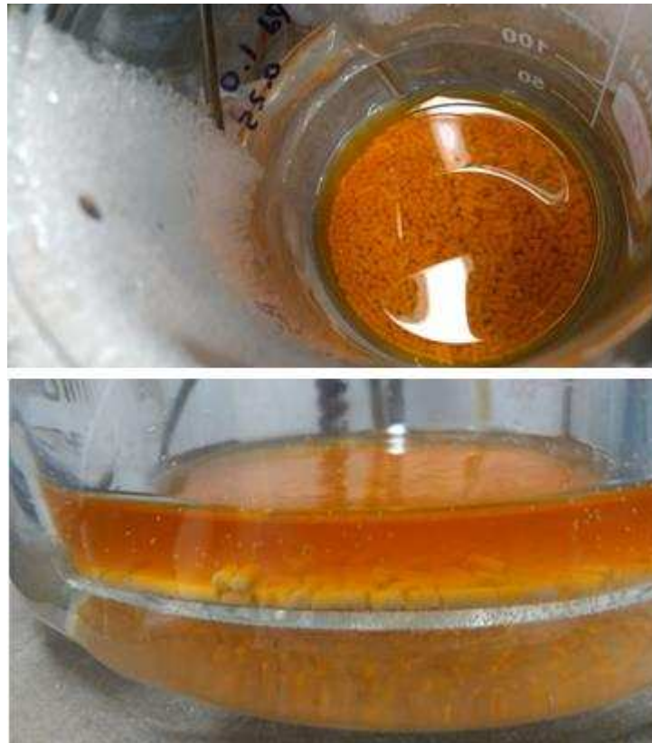
Figura 2. 3. Proceso de impregnación húmeda en pellets de alúmina con soluciones de \text{PdCl}_2 y \text{InCl}_3 .
