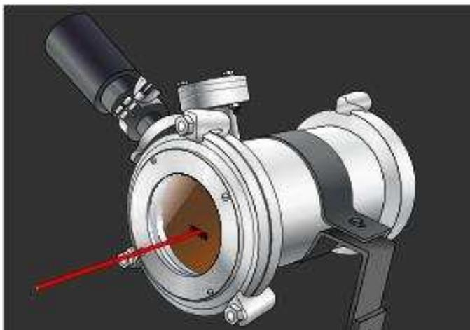
**Figura 2.6:** Crióstato donde se encuentra la muestra. Un haz de luz láser atraviesa el vidrio de la cámara de acero inoxidable, y luego pasa por la pequeña abertura en el recipiente de cobre, utilizado para uniformizar la temperatura, hasta llegar a la muestra [51].
