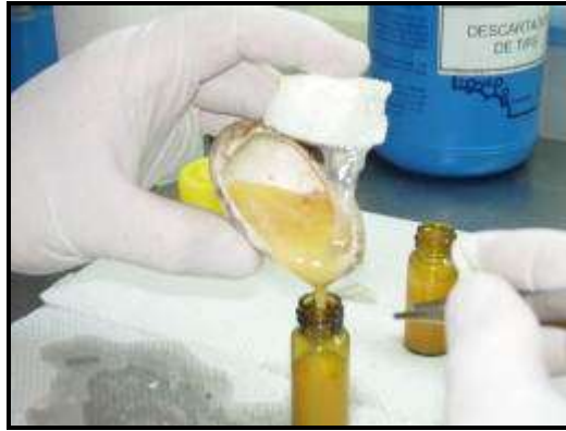
Figura 17. Obtención de la muestra utilizada para la detección de residuos de COCs.
