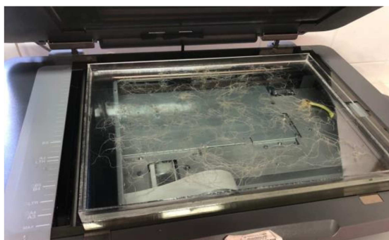
Figura 3 Escáner Epson con raíces dispersas en agua y listas para digitalizar.
