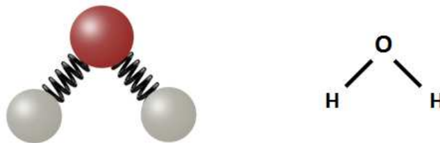
Fig. A1.1 -En mecánica molecular los átomos se representan por esferas y los enlaces entre ellos como resortes. Se ejemplifica el caso de la molécula de agua cuyo átomo de oxígeno está representado con una esfera roja y los hidrógenos con esferas blancas.
