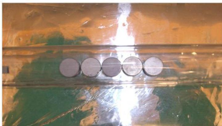
**Figura 11:** Foto de las muestras dispuestas en el interior del reactor tubular de cuarzo
