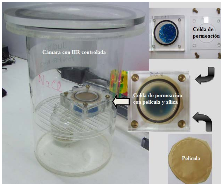
Figura III.3 – Dispositivo de medida de la permeabilidad al vapor de agua, en donde se puede observar la película colocada en la celda de permeación (con sílica en su interior, HR c = 0) dentro de una cámara con humedad relativa controlada (solución saturada de NaCl, HR d = 0,75).
