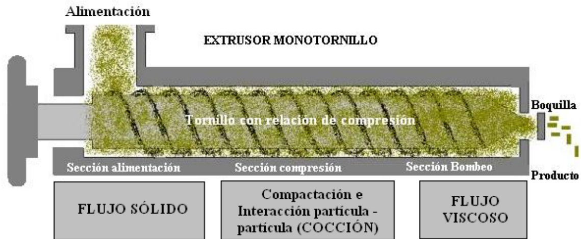
Figura I.20 – Transformaciones del material durante la extrusión (extrusor monotornillo).
