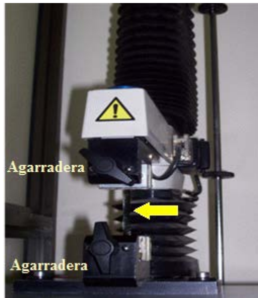
Figura III.4- Analizador de textura TA.XT2i, entre sus agarraderas una tira de película.
