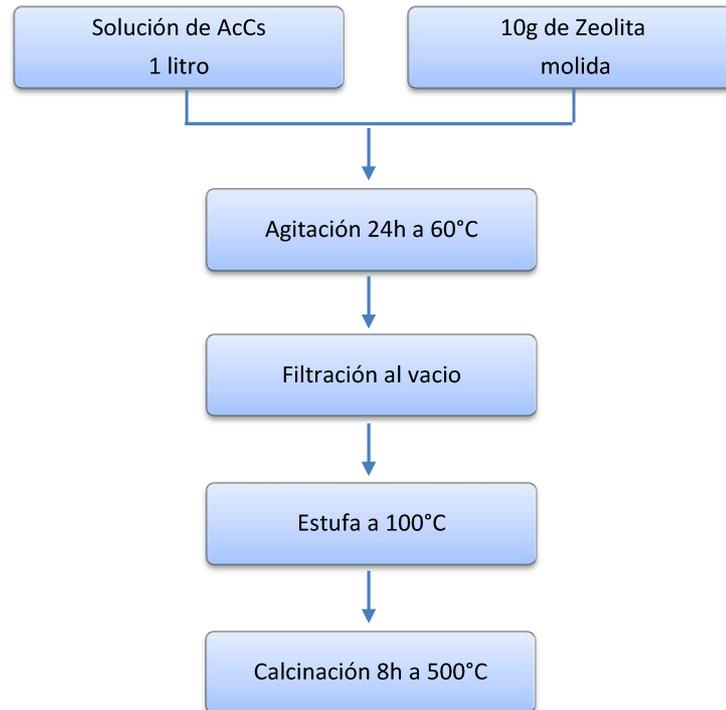
Fig. 3.3: Representación esquemática de la preparación del catalizador usando la técnica de intercambio iónico.
