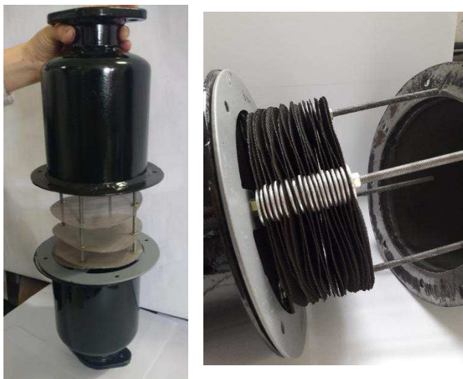
Figura 13. Carcasa con mallas metálicas apiladas en su interior – estructura escala banco.
