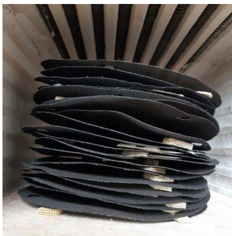
Figura 9. Mallas apiladas en la mufla, luego del pretratamiento térmico a 900 °C.
