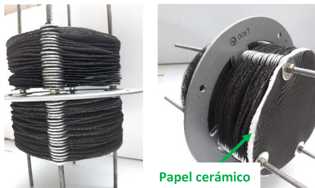
Figura 18. Mallas metálicas apiladas: (a) 20 de cada lado (40M) y (b) con el agregado del papel cerámico al final del lecho (40M + papel).
