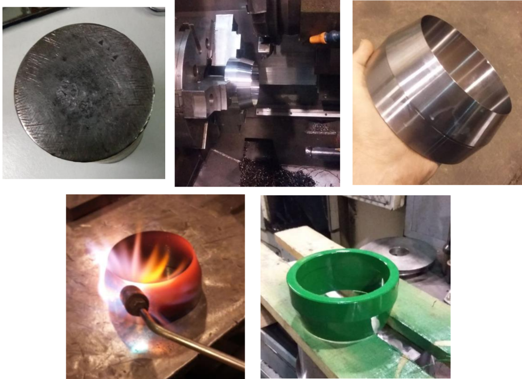
Figura 6. Construcción, templado y recubrimiento con pintura antioxidante del dispositivo para cortar los discos de malla metálica de 130 mm de diámetro.
