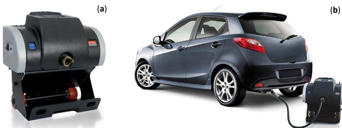
Figura 27. (a) Opacómetro OPABOX Autopower y (b) sonda ubicada en el caño de escape.
