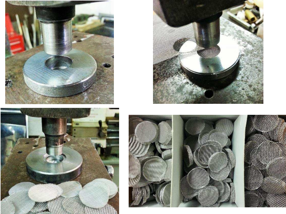
Figura 1. Matrices para el corte y pliegue de las tapas de los monolitos de mallas metálicas.
