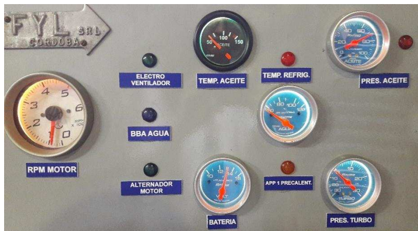
Figura 4. Tablero de control para monitorear las diferentes variables del banco de pruebas.
