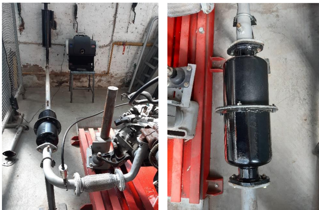
Figura 29. Carcasa acoplada al caño de escape del motor diésel.
