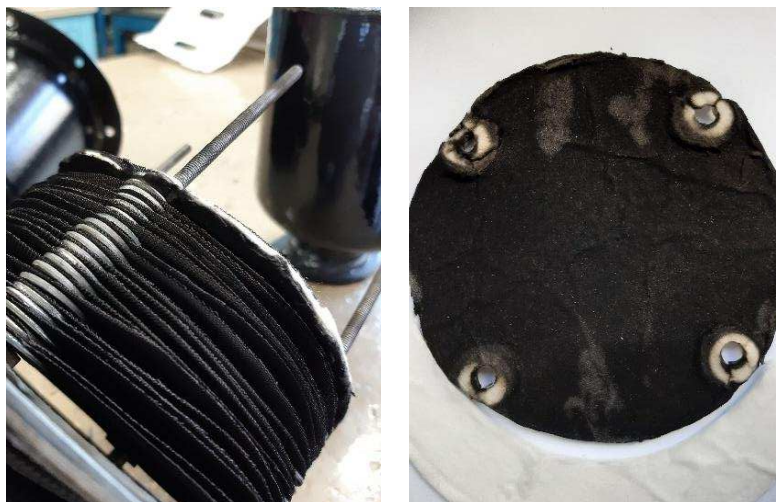
Figura 33. Papel cerámico con material particulado luego de los ensayos en el banco de pruebas.
