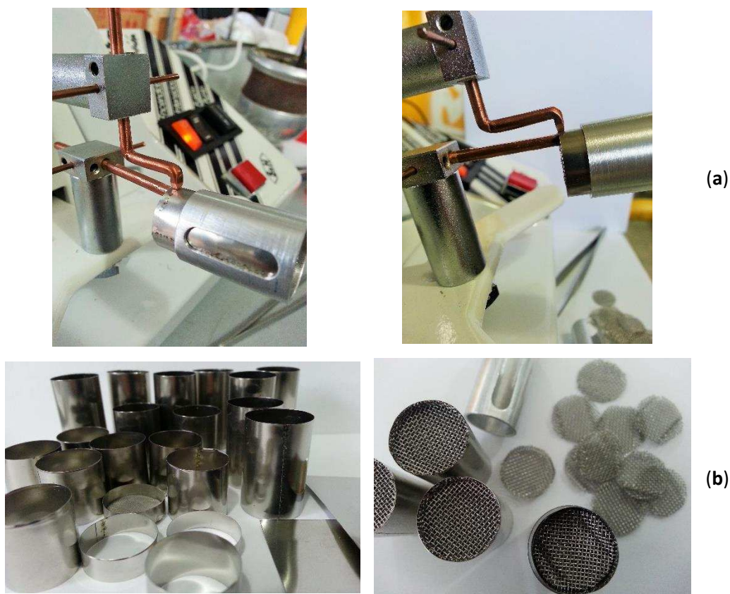
Figura 5. Confección de los cartuchos metálicos: (a) electrodos de cobre adaptados para soldar a lo largo de los cilindros y las tapas, (b) cilindros de distintas alturas con mallas metálicas apiladas.
