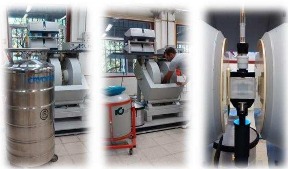
**Figura 3.** Fotos de los accesorios y de la cavidad del espectrómetro de EPR del Departamento de Física de la Facultad de Bioquímica y Ciencias Biológicas (UNL).
