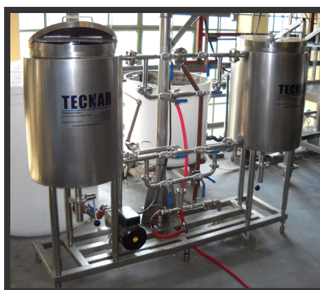
Figura IV. 1: Equipamiento utilizado para las elaboraciones de yogur a escala piloto de 30 L.
