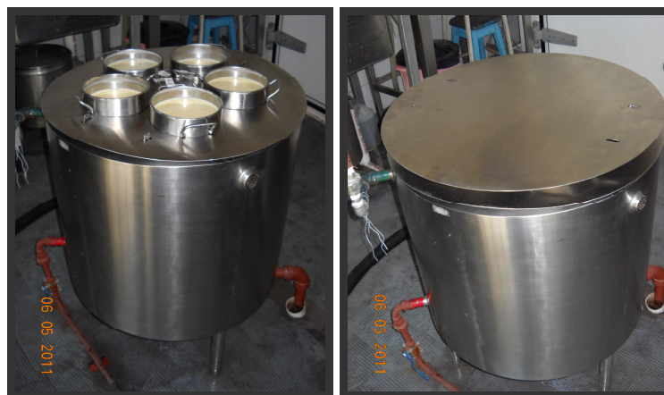
Figura I. 6: Equipamiento utilizado para la elaboración simultánea de 5 yogures diferentes a escala de 5 L.
