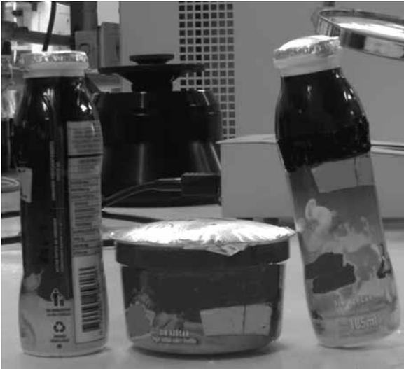
**Figura 1.** Aspecto que presentaron las muestras con evidentes alteraciones gasógenas (muestras 4, 5 y 6 de derecha a izquierda)
