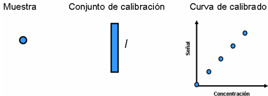
Figura 1.1. Datos de orden cero. Se genera un solo dato por muestra, y el conjunto de calibración es un vector que contiene las medidas para las I muestras de calibración. En la curva de calibrado, a cada valor de concentración le corresponde un dato de señal.
