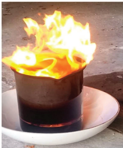
Figura 21. Quemado de combustible diésel YPF para generación de hollín.
