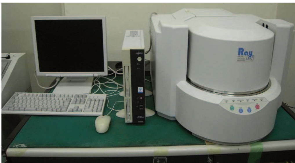
Figura 14. Fotografía del espectrómetro de FRX, Shimadzu EDX-720.
