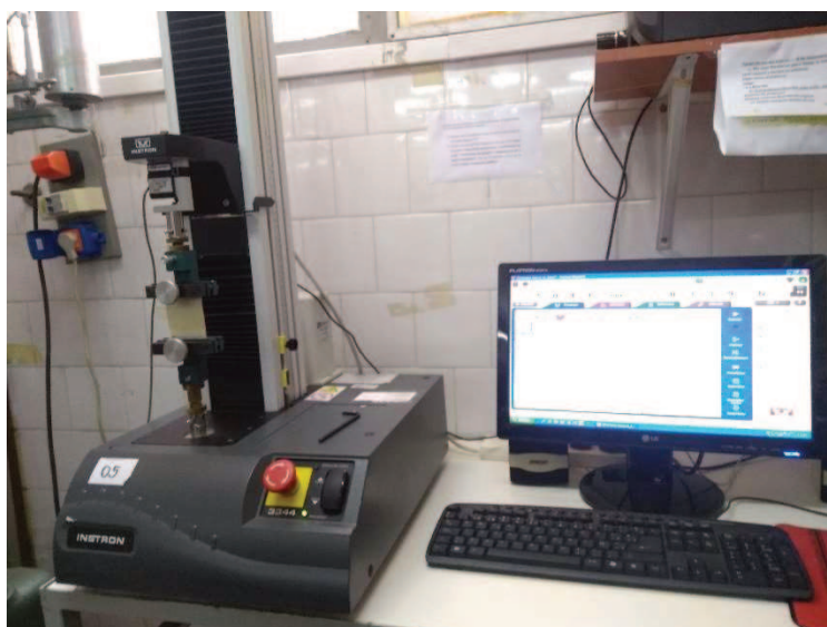
Figura 17. Fotografía del equipo de ensayos de tracción INSTRON 3344
