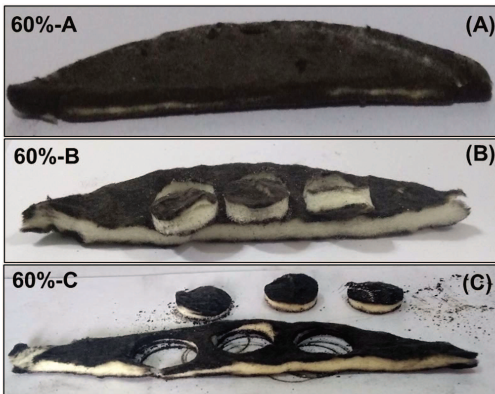
Figura 6. Fotografías de papeles cerámicos catalíticos impregnados a distancias variables respecto al ingreso de la niebla. (A) Papel ubicado más cercano al ingreso de la niebla. (B) Papel ubicado a distancia media (8 cm). (C) Papel impregnado a la mayor distancia. Ver posiciones A, B y C (Figura 3).
