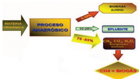
Figura 12: Proceso de tratamiento anaeróbico. Fuente: (Von Sperling, 2007).
