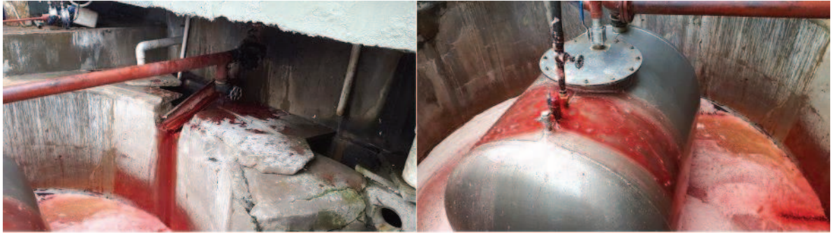
Foto 2: Captación y acumulación de sangre de segunda
