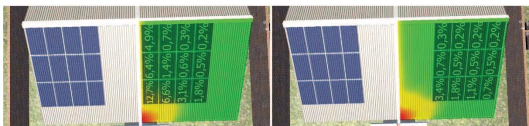
Fig. 108: Análisis de sombra para decidir ubicación del arreglo fotovoltaico.
