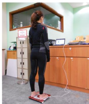
Figura 1. (a) plataforma de fuerza AMTI. (b) plataforma de fuerza para rehabilitación.
