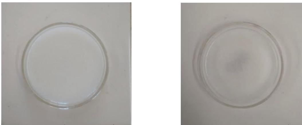
**Figura 2.** Secado de las membranas poliméricas. A) Gel de CMC B) Membrana polimérica de CMC luego de 5 h de secado.
