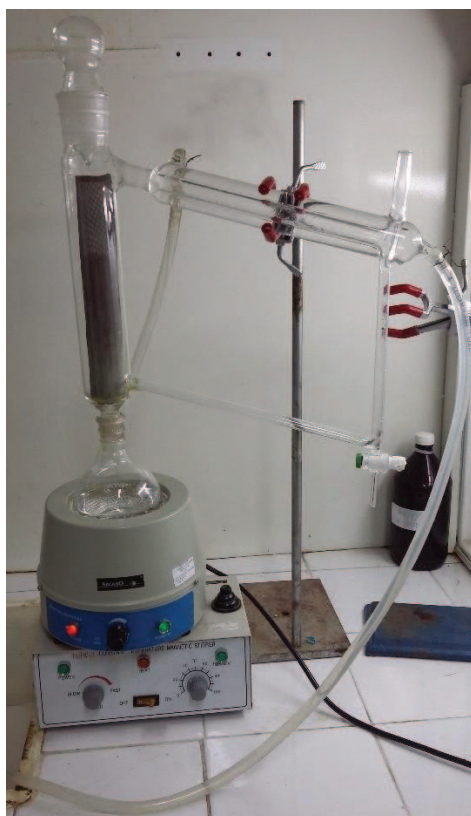
Fig. 4.3. Equipo de arrastre con vapor de agua, para extracción de AE.
