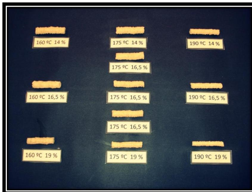
**Figura IV.30** Productos obtenidos por extrusión de la harina de arroz cáscara germinado, en diferentes condiciones de humedad y temperatura.
