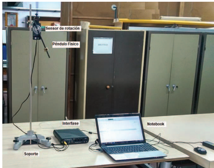
Figura 19. Péndulo físico asociado a un equipo informático de adquisición de datos
