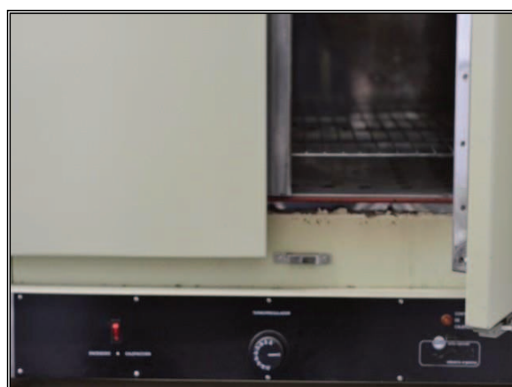
Figura 25- Estufa utilizada para secar material vegetal para determinación de masa seca
