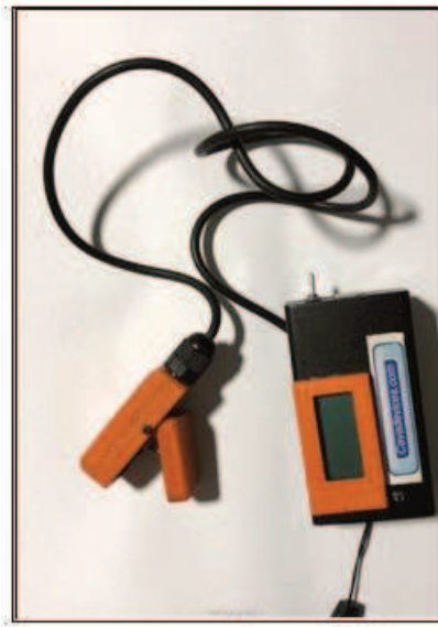
Figura 26- Instrumento para la medición del índice Spad
