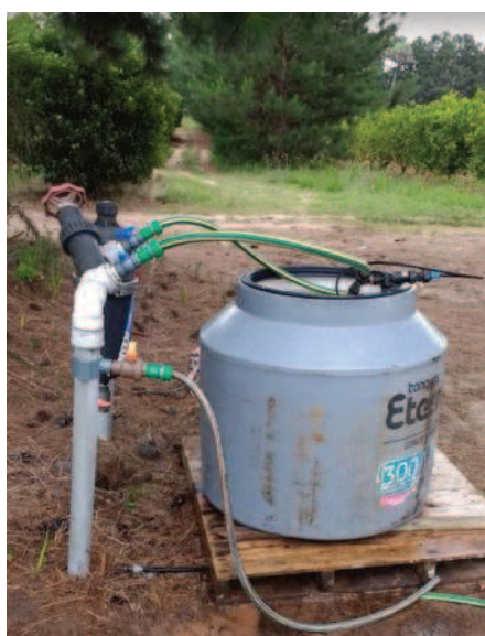
Figura N° 2. Tanque y venturi utilizado para aplicación de fertirriego en lote de naranja Salustiana.
