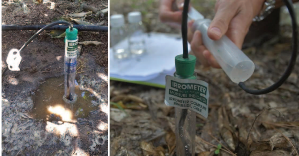
Figura N° 5. Extractor de solución de suelo (izquierda), extracción de solución (derecha).
