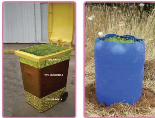
Figura 8: Cama biológica indirecta sin recirculación.
