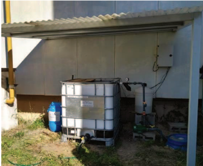
Figura 9: Cama biológica indirecta con recirculación construida en INTEC en el predio del CONICET Santa Fe
