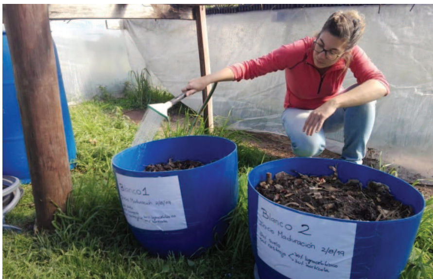
Figura 43: Riego para llevar la humedad al 80%
