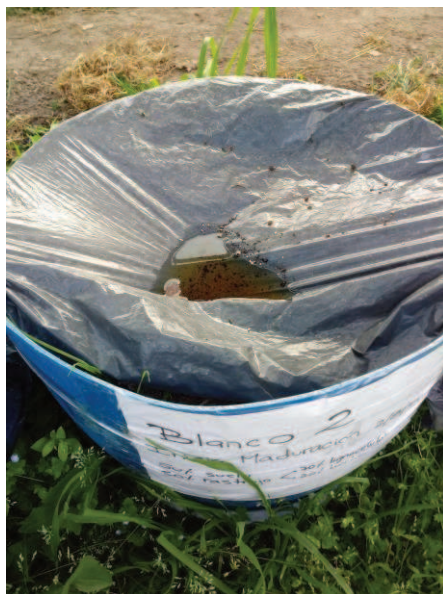
Figura 44: Funcionamiento de la cobertura de uno de los blancos después de una lluvia
