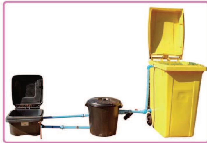
Figura 7: Cama biológica indirecta con recirculación.
