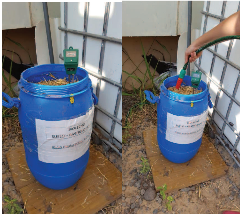
Figura 12: Cama biológica indirecta experimental.
