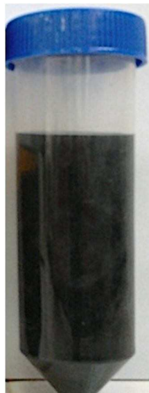
Figura VI- 20. Mezcla al final de la reacción; Catalizador: \gamma\text{-Al}_2\text{O}_3 ; W_{\text{catal.}} : 1,0 g; W_{\text{D-Xilosa}} : 1,5 g T: 140°C; P: 5 bar; Solvente: DMSO.
