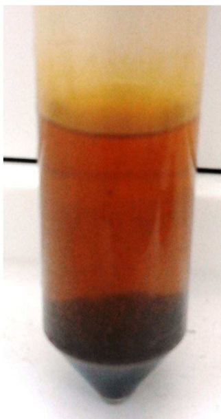
Figura VI- 6. Mezcla final de reacción de deshidratación de D-xilosa; Catalizador: \gamma\text{-Al}_2\text{O}_3 ; W_{\text{Catal.}} : 1,0 g; W_{\text{D-Xilosa}} : 1,5 g; T: 140^\circ\text{C} ; P: 6 bar; agitación: >500\text{rpm} ; solvente: agua.
