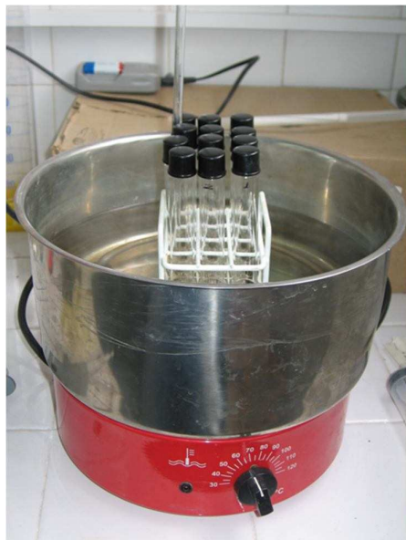
Figura V- 7. Baño termostatzado donde se lleva a cabo el proceso de derivatización de D-xilosa con PMP.
