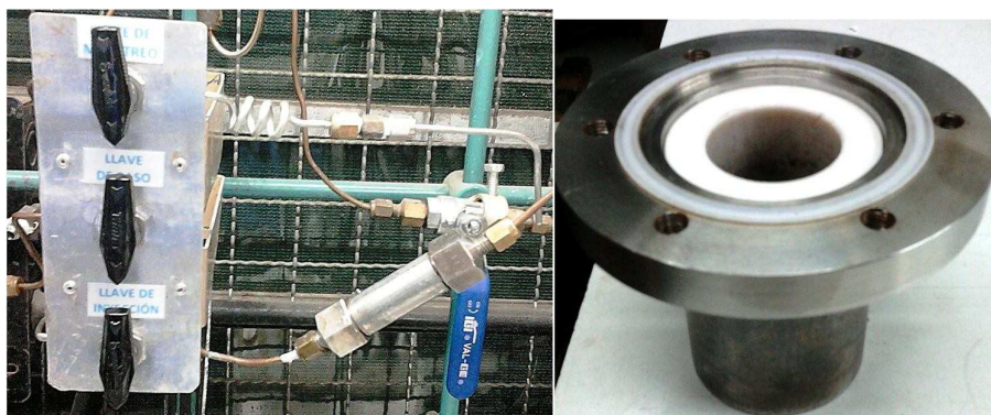
Figura V- 4. Llaves de tres vías para inyección, de paso y de muestreo (Izq.), vaso de teflón en el interior del reactor tipo parr (Der.).
