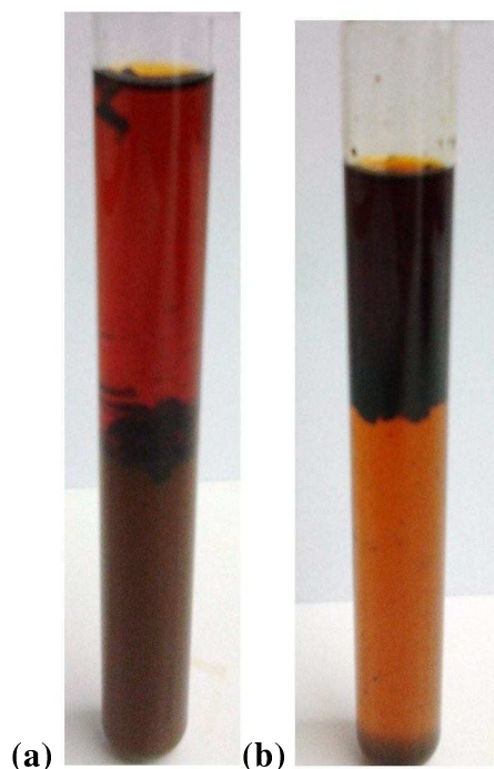
Figura VII- 13. Mezcla final de reacción de deshidratación de D-xilosa, (a) blanco de reacción (sin catalizador), (b) después de dos ciclos de 3 horas de reacción cada uno (6 horas de reacción total); Catalizador: \text{SiO}_2\text{-Al}_2\text{O}_3 ; W_{\text{Catal.}} : 1,0 g; W_{\text{D-Xilosa}} : 1,5 g; T: 160°C; P: 10 bar; Solvente: (50-50)% tolueno-agua; agitación: >500rpm.
