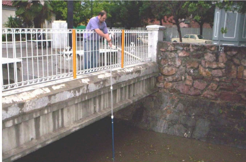
Figura 5.24: Ejecución de un aforo líquido en la sección de control.
