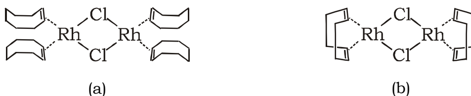
Esquema 4.1 Estructuras moleculares de los precursores de \text{Rh}[\text{I}] (a) Precursor con ligandos olefinicos monodentado, [\text{RhCl}(\text{C}_8\text{H}_{14})_2]_2 ; (b) Precursor con ligandos olefinicos bidentado, [\text{RhCl}(\text{C}_8\text{H}_{12})]_2
