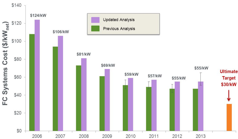
Figura 1.16. Costo (en US$) modelado y ajustado de un sistema PEMFC de 80 kW neto basado en la proyección de una alta capacidad productiva (500.000 unidades/año).
