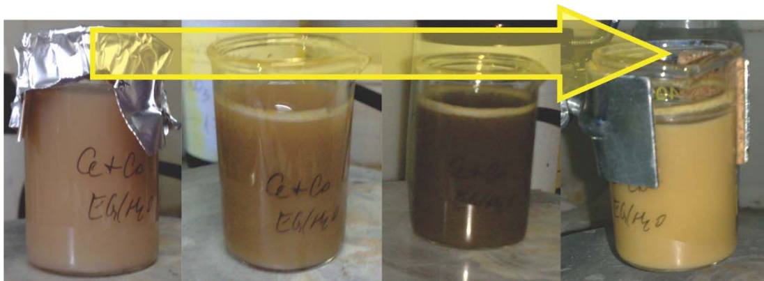
Figura 4.2. Evolución cromática en la síntesis de NP's por coprecipitación controlada de \text{CoO}_x\text{-CeO}_2 .
