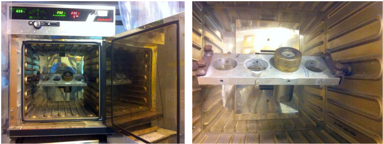
Figura 6.1. Estufa con sistema de rotación para la agitación de los autoclaves.
