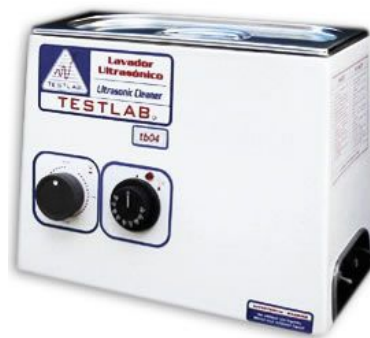
Figura 3.11. Baño ultrasónico Testlab TB04 (potencia = 160 W, frecuencia = 40 kHz).
