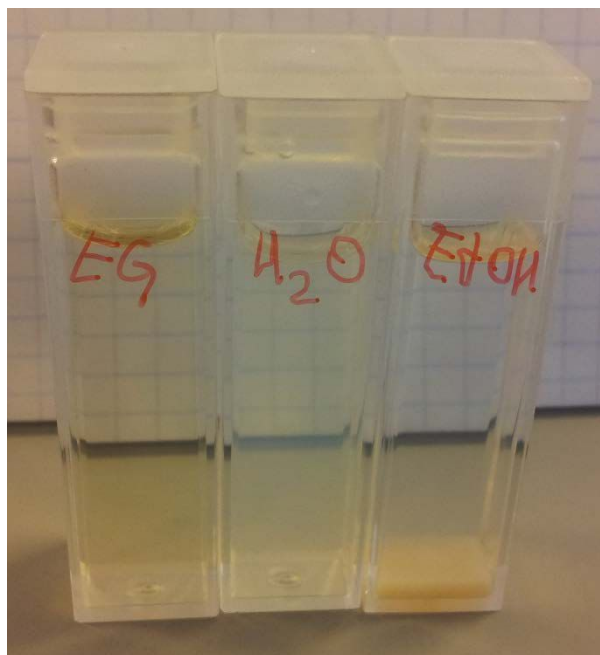
Figura 3.12. Estabilidad relativa de 100 µL de 4EG en 3,5 mL de EG (70 %V), H 2 O y EtOH.
