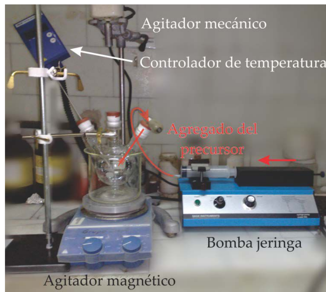
Figura 3.10. Equipo utilizado para la síntesis de NP's de CeO 2 mediante precipitación controlada por difusión.
