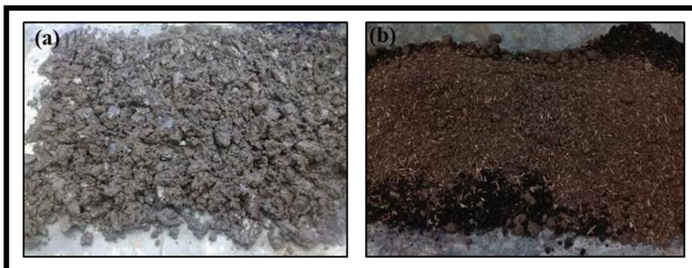
**Figura 3.3. (a) Lodo deshidratado por geotubos (b) mezclado de suelo y lodo deshidratado y secado al aire**
