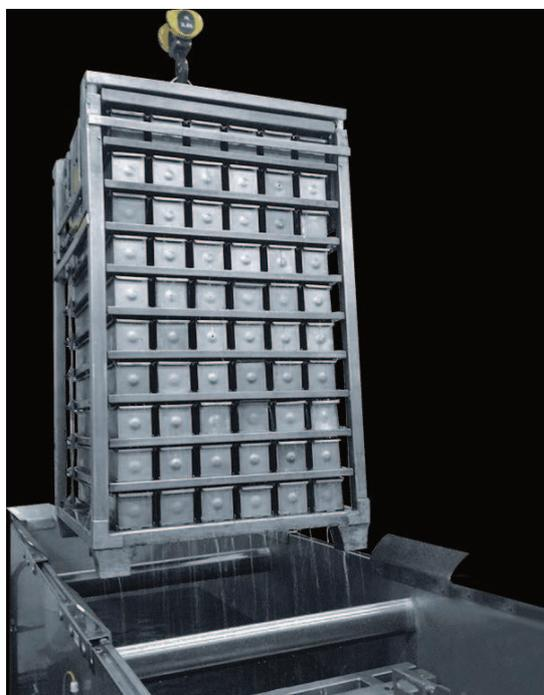
contenerlos con separadores para maximizar los espacios ocupados durante la cocción. Antes de su ingreso a las ollas que contienen el agua atemperada, las torres deben ser aseguradas mediante un sistema de compresión que efectúa la maquina prensadora.
